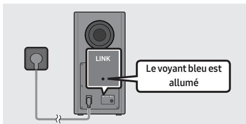
Le voyant LINK cesse de clignoter et s'allume en bleu fixe lorsque la connexion est établie entre le Soundbar et le caisson de basses sans fil.
