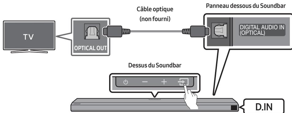
1. Le téléviseur et le Soundbar étant éteints, connectez le port **DIGITAL AUDIO IN (OPTICAL)** du Soundbar et le port de sortie OPTICAL du téléviseur à l'aide du câble optique (non fourni), comme indiqué sur la figure.
