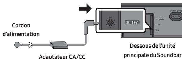
3. Connectez l'alimentation au Soundbar et au caisson des basses. Le caisson des basses est automatiquement connecté lorsque le Soundbar est allumé.
