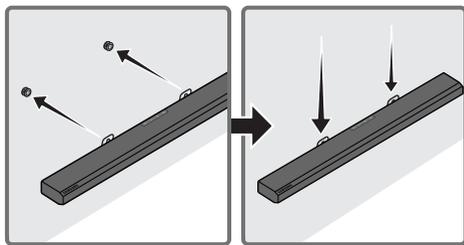
8. Faites glisser la Soundbar vers le bas, comme illustré ci-dessous, afin que les **Support de montage mural** reposent fermement sur les **Vis de fixation**.
