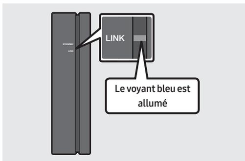
Le voyant LINK cesse de clignoter et s'allume en bleu fixe lorsqu'une connexion est établie entre le Soundbar et le module récepteur sans fil.
