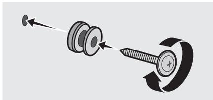
6. Installez les 2 **Support de montage mural** selon l'orientation correcte en bas de la Soundbar, à l'aide de 2 **Vis**.
