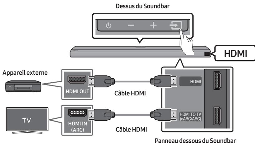
1. Utilisez un câble HDMI afin de connecter le port HDMI OUT de l'appareil externe et le port **HDMI** situé en dessous du Soundbar.
