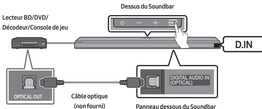
1. Utilisez un câble optique (non fourni) pour connecter le port **DIGITAL AUDIO IN (OPTICAL)** au Soundbar principal et le port **OPTICAL OUT** à l'appareil externe.
