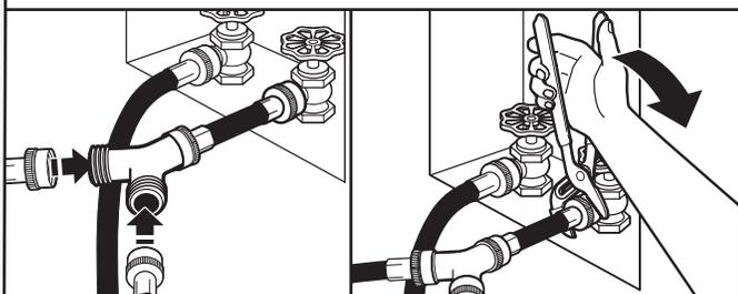
Fixer une des extrémités du tuyau d'arrivée d'eau de 5 pi (1,5 m) au connecteur en "Y". Fixer le tuyau d'alimentation en eau froide de la laveuse à l'autre extrémité du raccord en "Y". Visser le raccord à la main pour qu'il repose sur le connecteur. Terminer le serrage des raccords – deux tiers de tour supplémentaires avec une pince.
