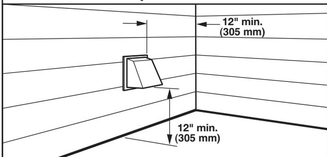
Installer le clapet d'évacuation et utiliser un composé de calfeutrage pour calfeutrer le côté extérieur de l'ouverture murale autour du clapet d'évacuation.
