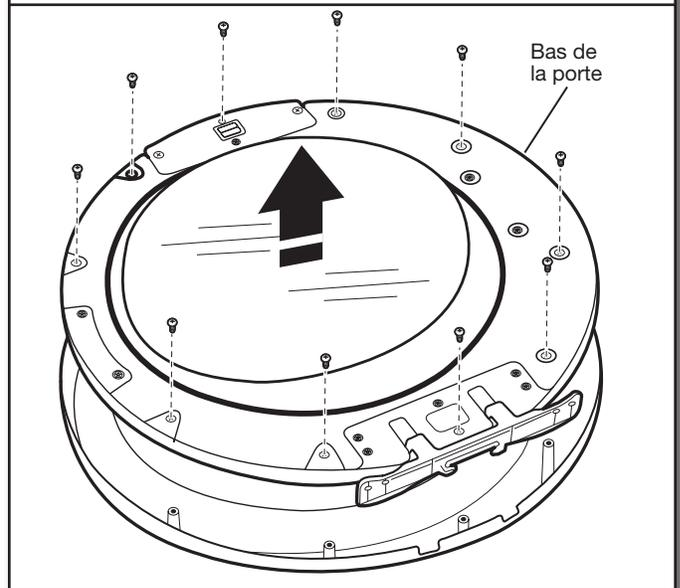
Positionner la porte de façon à ce que l'intérieur de la porte soit orienté vers le haut. Réinstaller les 10 vis fixant la porte interne à la porte externe.
