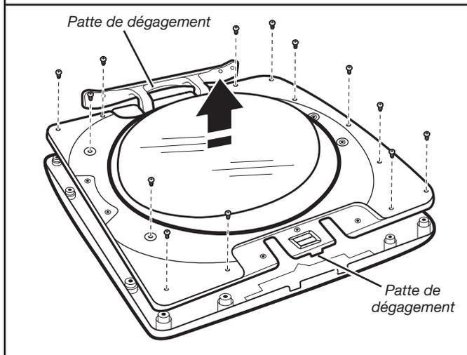
Positionner la porte de façon à ce que l'intérieur de la porte soit orienté vers le haut. À l'aide d'un tournevis Phillips, retirer les 13 vis fixant la porte interne à la porte externe. Soulever la porte interne pour la dégager et la mettre de côté.
