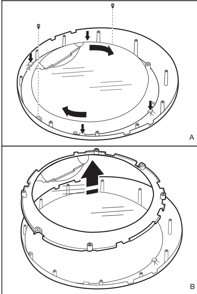
À l'aide d'un tournevis Phillips, retirer les deux vis du support de la partie externe du hublot et faire pivoter la partie externe du hublot dans le sens horaire jusqu'à ce que les indentations carrées soient alignées avec les quatre onglets de la garniture circulaire aux emplacements indiqués par les flèches dans l'illustration A ci-dessus. Soulever ensuite la partie externe du hublot et le support, et les dégager de la garniture circulaire – les mettre de côté (B).
