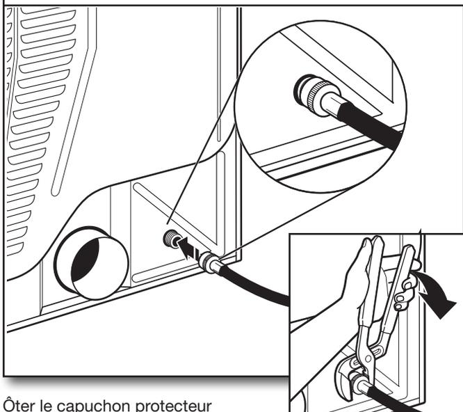
Ôter le capuchon protecteur de l'orifice d'arrivée d'eau. Fixer l'extrémité inclinée du long tuyau au robinet de remplissage au bas du panneau arrière de la sécheuse. Visser complètement le raccord à la main pour qu'il soit scellé au raccord du robinet de remplissage. Terminer le serrage des raccords – deux tiers de tour supplémentaires avec une pince.
