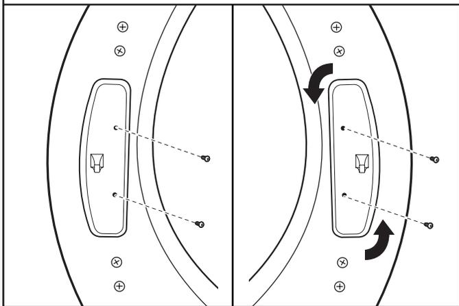
À l'aide d'un tournevis TORX® T25®, retirer les deux vis fixant la gâche de la porte au châssis de la porte de la sécheuse. Faire pivoter la gâche de 180° et la fixer au côté opposé du châssis de la porte de la sécheuse, tel qu'indiqué.
