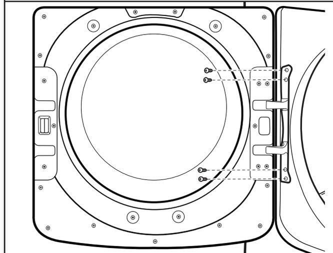
À l'aide d'un tournevis TORX® T25®, réinstaller les quatre vis fixant la charnière de la porte à la sécheuse.
