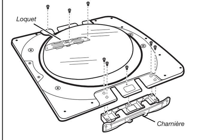
À l'aide d'un tournevis TORX® T25®, réinstaller la plaque de protection du loquet, la plaque de support du loquet et la charnière sur les côtés dont elles ont été respectivement retirées.
