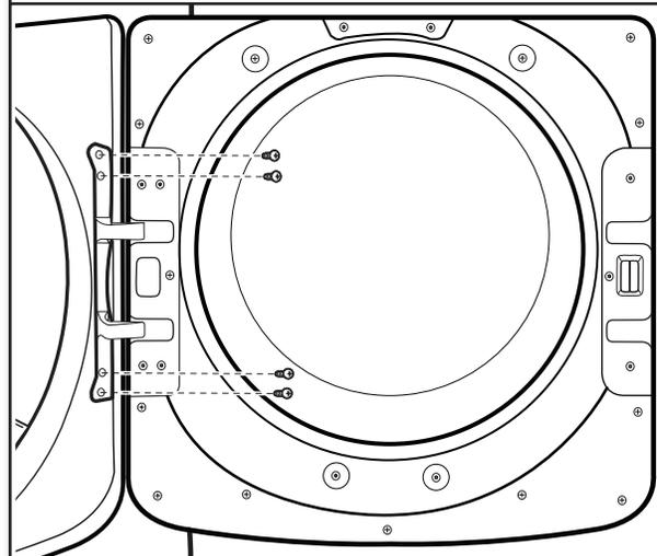
À l'aide d'un tournevis TORX® T25®, retirer les quatre vis fixant la charnière de porte à la sécheuse et soulever la porte pour la retirer. Placer la porte sur une serviette douce ou sur une surface lisse. Conserver ou mettre les quatre vis de côté.
