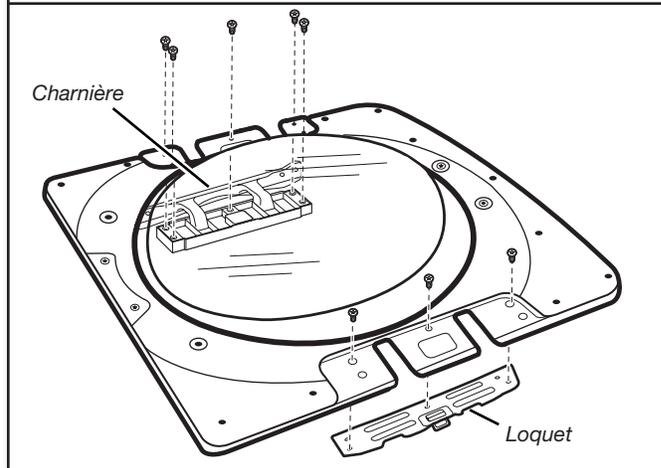
À l'aide d'un tournevis TORX® T25®, retirer les trois vis TORX® fixant la plaque de protection du loquet et la plaque de support du loquet; retirer aussi les cinq vis maintenant la charnière en place.
