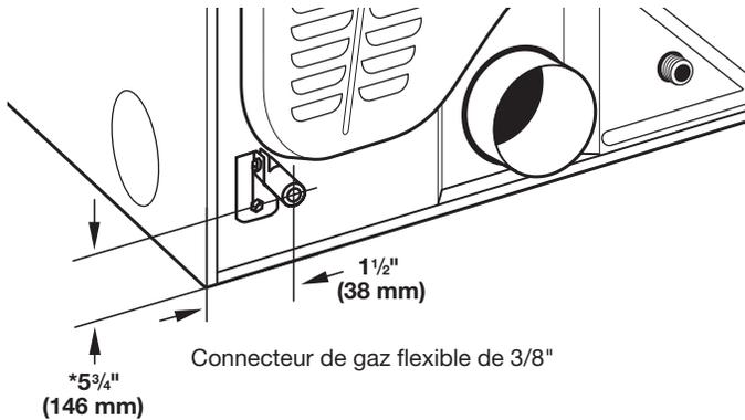
**\*REMARQUE :** Si la sècheuse est montée sur un piédestal, prévoir 10" (254 mm) ou 15,5" (394 mm) de plus à partir du sol pour la hauteur de la canalisation d'arrivée de gaz, en fonction du modèle de piédestal. Pour une installation dans un garage, prévoir 18" (460 mm) de plus à partir du sol pour la hauteur de la canalisation d'arrivée de gaz.
