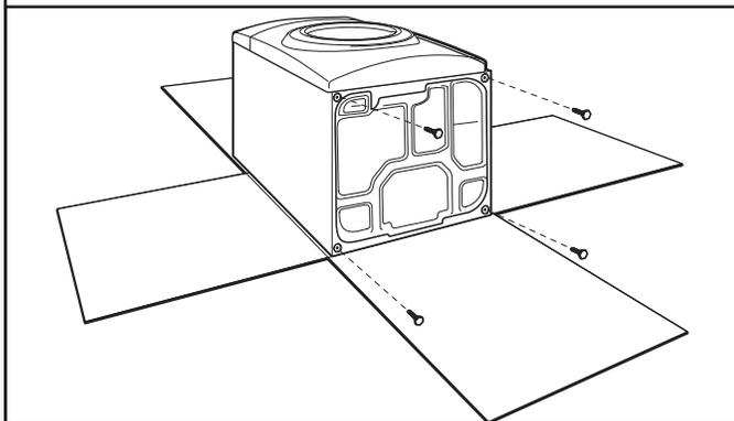
Pour ne pas endommager le plancher, utiliser une grande pièce de carton de l'emballage de la sècheuse; la placer sous tout le bord arrière de la sècheuse. Saisir fermement la sècheuse par la caisse (non par le panneau de commande) et incliner soigneusement la sècheuse sur le carton.
