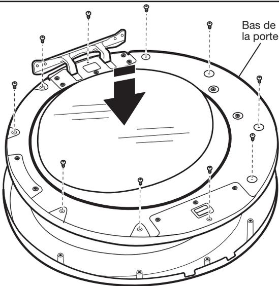
Positionner la porte de façon à ce que l'intérieur de la porte soit orienté vers le haut. Réinstaller les 10 vis fixant la porte interne à la porte externe.
