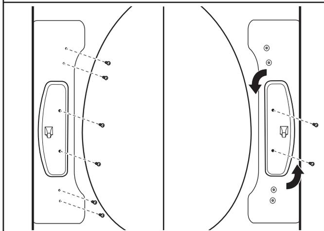
À l'aide d'un tournevis TORX® T25®, retirer les deux vis fixant la gâche de la porte au châssis de la porte de la sécheuse. Retirer les quatre vis au-dessus et en dessous de la gâche de la porte et les mettre de côté pour utilisation ultérieure. Faire pivoter la gâche de 180° et la fixer au côté opposé du châssis de la porte de la sécheuse, tel qu'indiqué.
