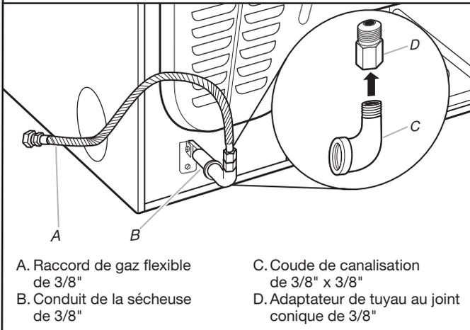
On doit utiliser une combinaison de raccords de canalisation pour raccorder la sècheuse à l'alimentation en gaz existante. Un raccordement est illustré. Le raccordement peut varier, selon le type d'alimentation, la dimension et l'emplacement.
