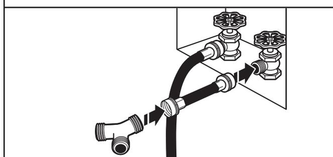
Fixer un tuyau d'arrivée d'eau court au robinet d'eau froide. Visser complètement le raccord à la main pour qu'il soit scellé au robinet. Puis fixer le raccord en "Y" à l'extrémité mâle du tuyau d'arrivée d'eau court. Visser complètement le raccord à la main pour qu'il soit scellé au connecteur en "Y".
