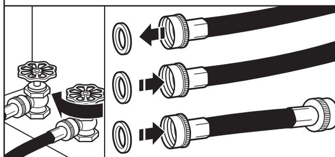
Arrêter le robinet d'eau froide et retirer le tuyau d'alimentation de la laveuse.
