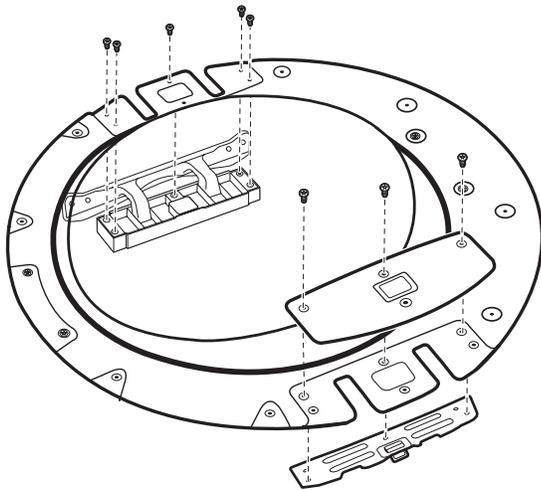
Au moyen d'un tournevis TORX® T25®, remonter la plaque de protection du loquet et la plaque de support du loquet avec les trois vis TORX® ôtées précédemment, ainsi que la charnière avec les cinq vis, du côté opposé à celui duquel elles ont été enlevées.
