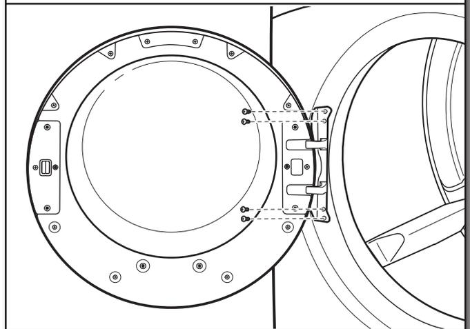
À l'aide d'un tournevis TORX® T25®, retirer les quatre vis de la sécheuse. Insérer les onglets sur la charnière dans l'encoche de montage et les faire glisser vers le bas pour engager l'onglet supérieur. Fixer avec les quatre vis TORX® T25® précédemment retirées.
