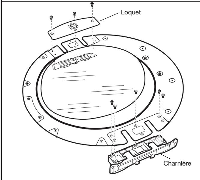
À l'aide d'un tournevis TORX® T25®, retirer les trois vis TORX® fixant la plaque de protection du loquet et la plaque de support du loquet; retirer aussi les cinq vis maintenant la charnière en place.
