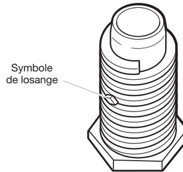
Examiner les pieds de nivellement, trouver le symbole de losange. Introduire manuellement les vis des pieds dans les trous, puis utiliser une clé à molette pour visser les pieds jusqu'à ce que le symbole de losange ne soit plus visible.
