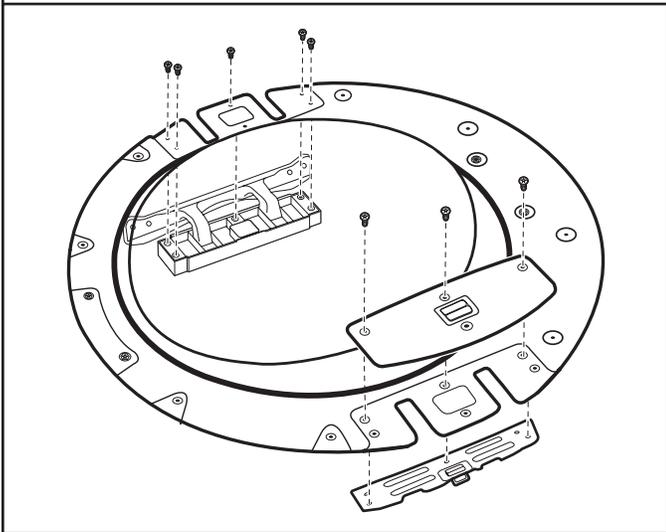
À l'aide d'un tournevis TORX® T25®, réinstaller la plaque de protection du loquet, la plaque de support du loquet et la charnière sur les côtés dont elles ont été respectivement retirées.
