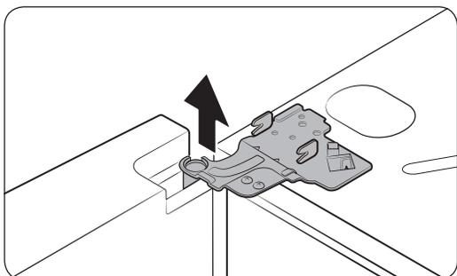
5. Abra la puerta a 90 grados. Mientras sostiene la puerta, levante y retire la bisagra superior. Tenga cuidado de no dañar los cables de los conectores al retirar la bisagra.
