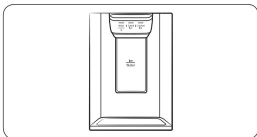
1. Con la fábrica de hielo activada, presione **Cubed Ice (Hielo en cubos)** o **Crushed Ice (Hielo triturado)** para seleccionar el tipo de hielo.
