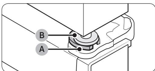
2. Insérez un circlip (A) de taille appropriée entre l'œillet de la porte (B) et la charnière, comme indiqué.
