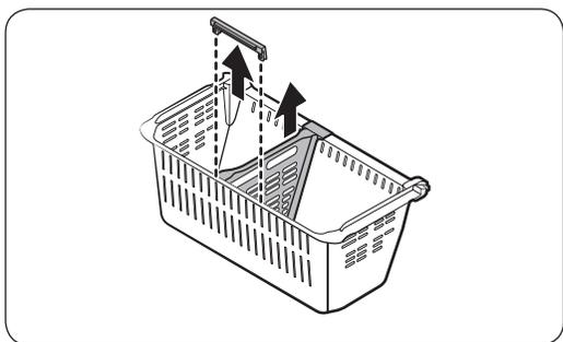
3. Tirez vers le haut la **fixation arrière** et la **grille de séparation** pour permettre le retrait.
