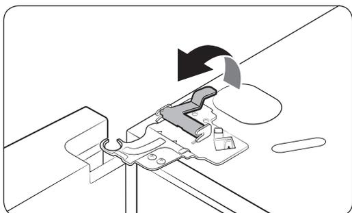
1. Con las puertas cerradas, utilice un destornillador de cabeza Phillips para extraer los tornillos (x3) de la cubierta superior.
