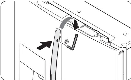
4. Inserte la llave provista en el orificio de la manija y gírela en el sentido de las agujas del reloj para ajustarla.
