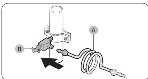
3. Raccordez le kit d'installation de la conduite d'eau (A) au robinet de sectionnement (B).
