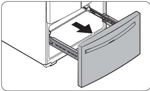
4. Mientras sostiene la parte superior del frente del cajón del congelador, deslícelo hacia afuera para retirar el cajón del congelador del conjunto de riel.
