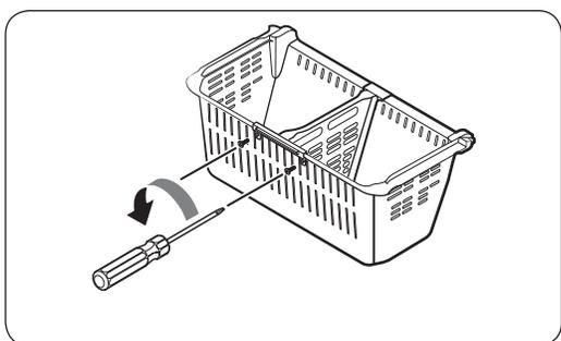
2. Utilisez un tournevis cruciforme pour dévisser les deux vis maintenant en place la **fixation arrière** à l'arrière du bac.
