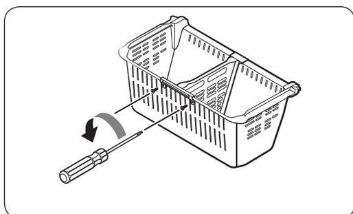
2. Utilice un destornillador Phillips para desenroscar los dos tornillos que ajustan el  **fijador posterior** en la parte posterior de la cesta.
