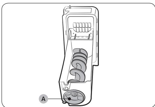
1. Para retirar la cubeta de hielo, levántela suavemente y tire hacia afuera mientras sostiene la parte inferior de la cubeta con una mano y el lado con la otra.
