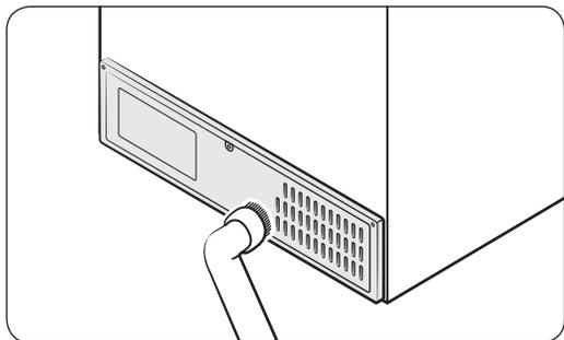
Para mantener los cables y las partes expuestas del panel posterior libres de polvo, aspire el panel una o dos veces al año.
