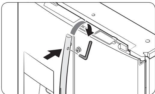
4. Insérez la clé fournie dans le trou de la poignée, puis faites-la tourner dans le sens horaire pour la serrer.
