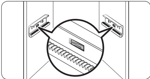
3. Appuyez sur les crochets pour déverrouiller les rails.
