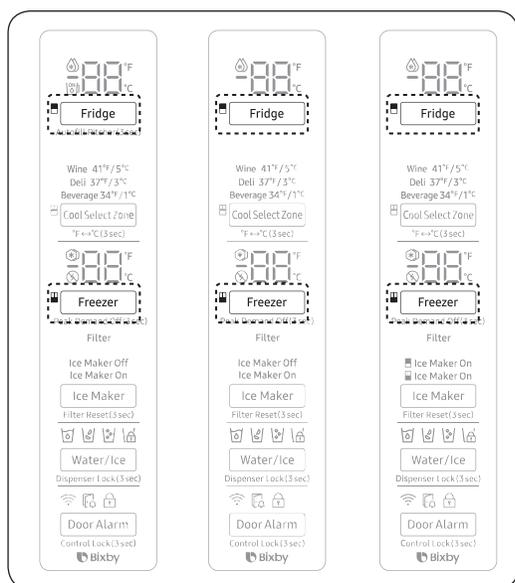
1. En este modo, la dirección MAC aparece en el panel de temperatura (en las secciones del congelador y del refrigerador del panel) en forma secuencial durante 1 minuto. Mantenga presionados **Freezer (Congelador)** y **Fridge (Refrigerador)** durante 6 segundos. El panel de temperatura titila. Luego, presione **Freezer (Congelador)** nuevamente para visualizar la dirección MAC. El refrigerador emite una señal sonora.
