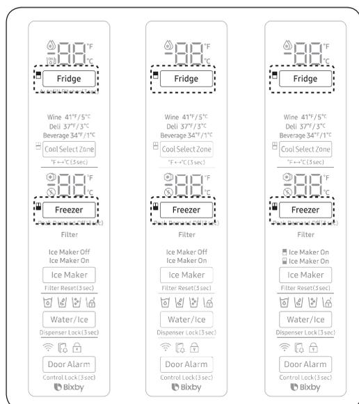
1. Dans ce mode, l'adresse MAC apparaît sur le panneau de température (sur les sections congélateur et réfrigérateur du panneau) pendant 1 minute, en suivant un certain ordre. Maintenez **Freezer (Congélateur)** et **Fridge (Réfrigérateur)** simultanément enfoncés pendant 6 secondes. Le panneau de température clignote. Ensuite, appuyez à nouveau sur le bouton **Freezer (Congélateur)** pour afficher l'adresse MAC. Le réfrigérateur émet un signal sonore.
