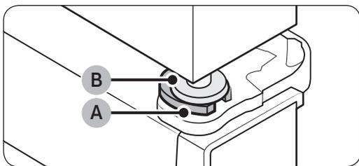
2. Inserte un anillo elástico (A) del tamaño adecuado entre el anillo de caucho (B) de la puerta y la bisagra como se ilustra.
