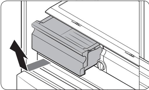
Levante suavemente el frente del cajón y deslícelo hacia afuera.
