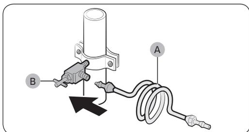
3. Conecte el equipo de instalación de la tubería de agua (A) a la válvula de cierre (B).
