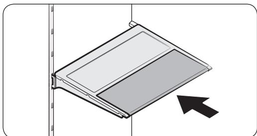
Puede deslizar hacia adentro la parte delantera del estante para almacenar más elementos. Jale suavemente la parte delantera del estante para usarlo completo de nuevo.
