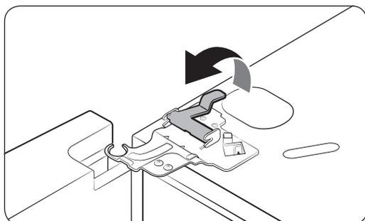
1. Après avoir fermé les portes, utilisez un tournevis cruciforme pour retirer les vis (x3) au niveau du cache supérieur.
