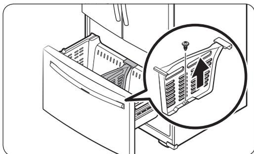
Afloje y retire el tornillo de la parte inferior del separador. Jale hacia arriba para extraer el separador.
