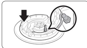
2. Instale el cabezal del quemador de modo que el electrodo pase por la abertura para el electrodo. Asegúrese de que el cabezal del quemador quede plano en la parte superior de la estufa.
