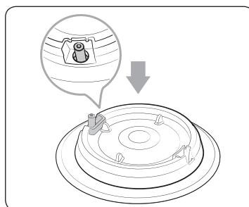
2. Instale el cabezal del quemador de modo que el electrodo pase por la abertura para el electrodo. Asegúrese de que el cabezal del quemador quede plano en la parte superior de la estufa.
