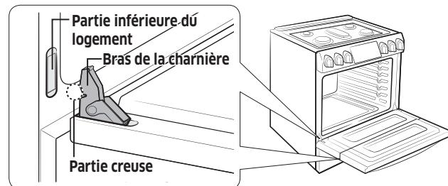
3. Ouvrez la porte au maximum. Si la porte ne s'ouvre pas complètement, c'est que la partie creuse n'est pas correctement insérée dans la partie inférieure du logement.
