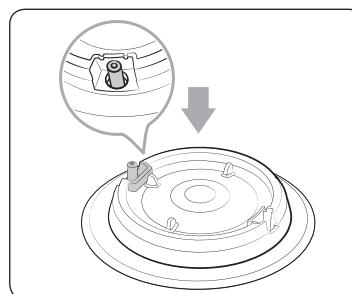
2. Installez la tête du brûleur afin que l'électrode passe à travers l'ouverture destinée à l'électrode. Assurez-vous que la tête du brûleur porte bien à plat sur le dessus de la cuisinière.
