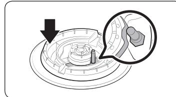
2. Installez la tête du brûleur afin que l'électrode passe à travers l'ouverture destinée à l'électrode. Assurez-vous que la tête du brûleur porte bien à plat sur le dessus de la cuisinière.
